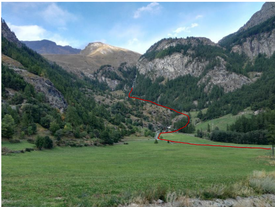
Figura 4.4: vista d'insieme del tracciato della condotta
